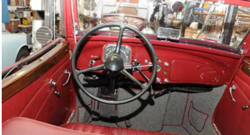
Instrumenter og annet måtte bygges om til 12 volt. Dashbordet ble supplert med en oljetrykkmåler, sigarett-tenner for å bruke GPS, og varsellampe for lading. Det er ingen lampe eller termometer for vanntemp, men det skal bygges inn senere. Girspaken fra dashbordet (kuhale, på fransk folkemunne) krever tilvenning, men etter hvert fungerer den meget bra.
