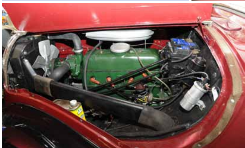
Vi ser her den nye Dynatoren som har utseende som den gamle 6 V dynamoen, men er en 12 vekselstrøms-generator, fin og dyr (ca 8000 kr. En som ser moderne ut får du fra ca. 2000 kr.) Vi ser også fallforgasseren på «perfo»-motoren og det moderne luftfilteret.
