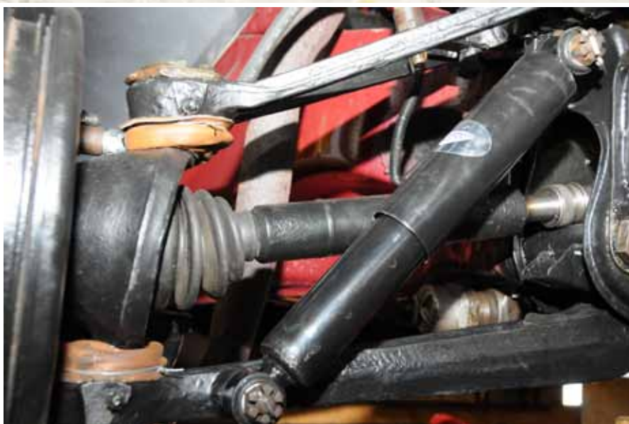
Høyre forhjul fra forsiden med ny drivaksel, lærmansjetter og helt nye støtdempere som ble skifta rund baut
