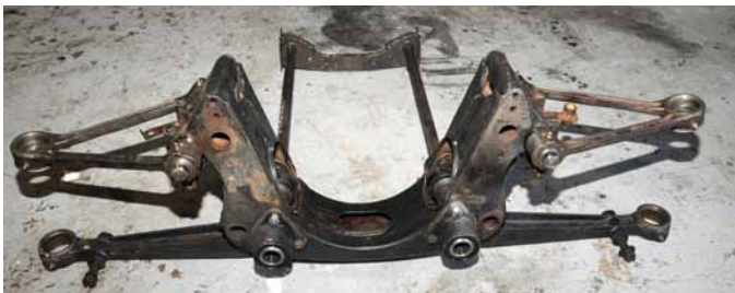
▲ Etter at motor og forstilling var ute kunne hjelperammen med torsjonsfjærer og forstillingsarmer trekkes ut. Nye silentblocks (gummiforinger) og hovedforingen for øvre bæreammer krevde en mann med en presse for 60 tonn, så den ble sendt bort og kom perfekt tilbake.
