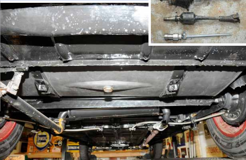
▼ Hele gulvet i bilen ble skiftet. Vi ser badeslangene som ble brukt som strømpe på bremsevaierne til håndbremsen. Bensintanken ble syrevasket og forseglet innvendig.
