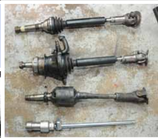
▲ Drivakslene var svært gamle og muligens originale. Tidlige forhjulsdrevne biler har stor svingradius, og det ble lovet forbedring med de nye drivakslene. De veide dessuten mindre, ca 4 i stedet for litt over 7 kg pr. stk. Øverst en ny aksel, den neste er ny med påmontert hjulnav. Nederst den gamle og et verktøy. De nye akslene ble kjøpt gjennom den norske klubben.
