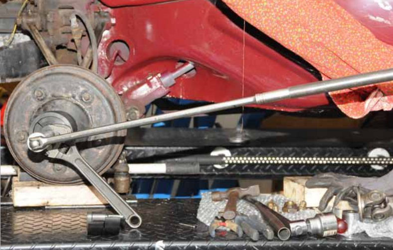
▼ Hele gulvet i bilen ble skiftet. Vi ser badeslangene som ble brukt som strømpe på bremsevaierne til håndbremsen. Bensintanken ble syrevasket og forseglet innvendig.
