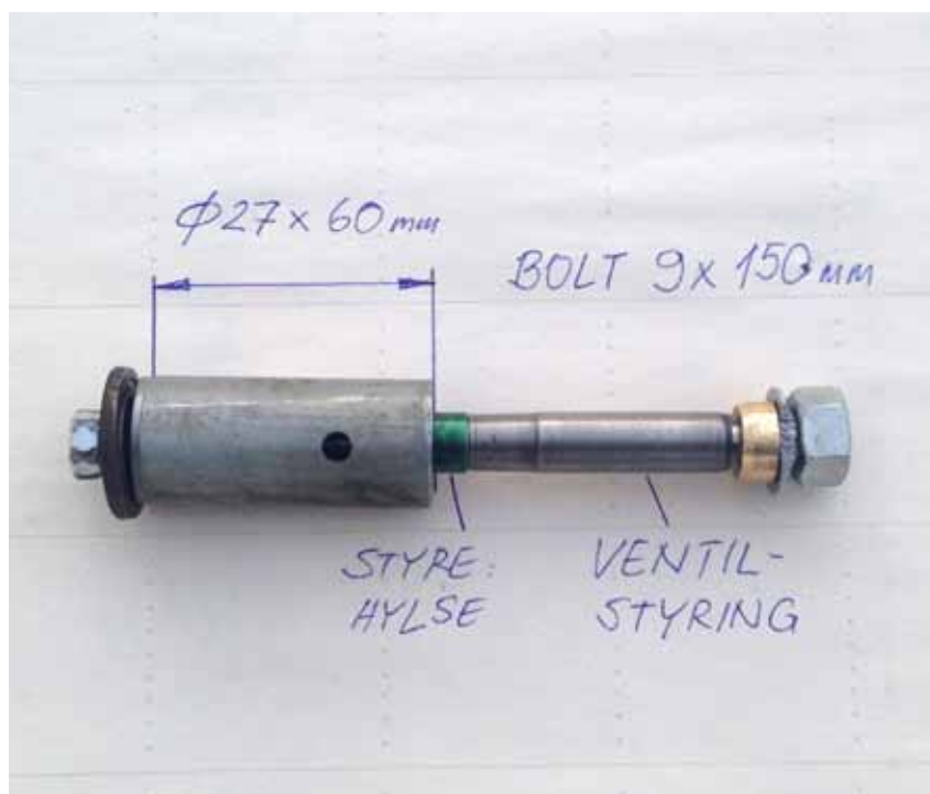
Hjemmelaget styringsmonteringsverktøy.
