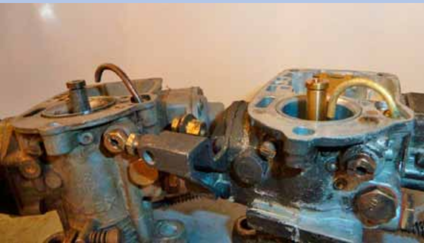
Den «nye» forgasseren ser langt fra ny ut, men dette kommer av at den har vært i en brann, så den er sotet utvendig.
