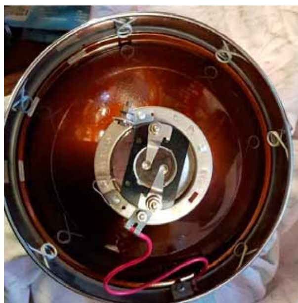
Original-innsats med Ba21d. Legg merke til jordingskabelen.
